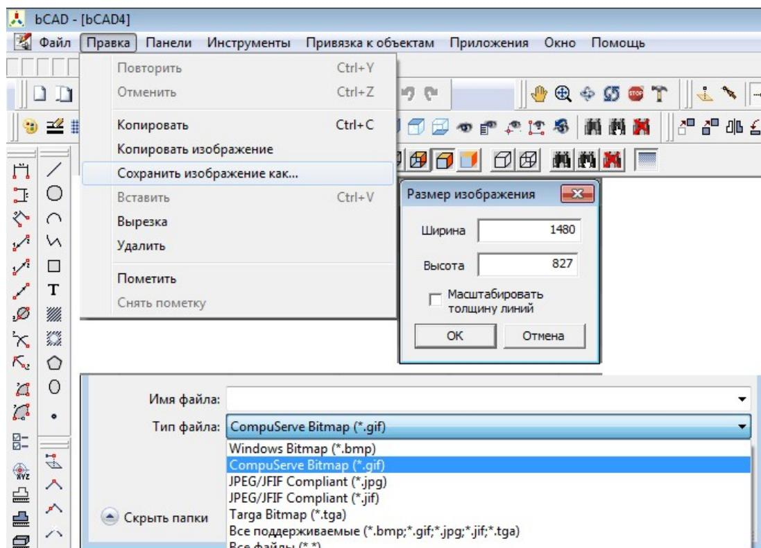
В результате Вы сразу из программного пакета «bCAD Мебель Про» и его модификаций получите растровую картинку с изображением рабочего экрана на текущий момент при любом режиме отображения.
